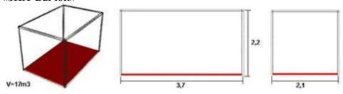
По своим основным потребительским качествам (тоннаж, объём, габаритные размеры) к автомобилям класса "ЗИЛ-Бычок" можно отнести различные модели отечественных и импортных грузовиков. Грузовые отсеки этих автомобилей могут незначительно отличаться по габаритным размерам и, соответственно, объёмам.
