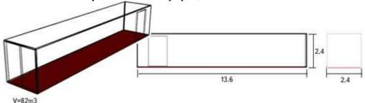
Изотермический полуприцеп объёмом 82 м3 имеет схожие потребительские свойства с изотермическими фургонами меньшего размера. Эталонными, для данного типа полуприцепа можно считать следующие габаритные размеры:
