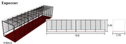
"Евротент" - условное понятие обозначающее грузовой автомобиль с полуприцепом имеющим габаритные размеры, близкие к указанным характеристикам. В еврофуру, как иначе называют евротент, вмещается по ширине поставленные поперек 2 европоддона длиной 120 см каждый.
